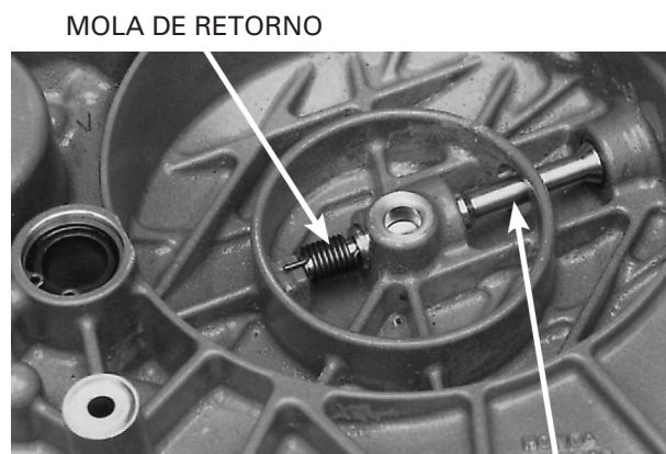
EIXO DO BRAÇO DE ACIONAMENTO DA EMBREGEM
